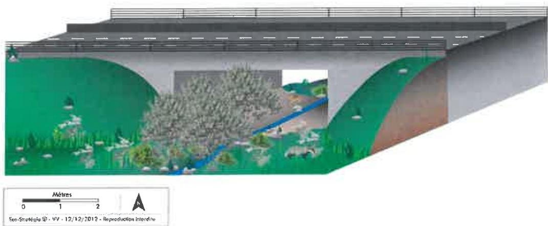
*Vue de principe de l'ouvrage de rétablissement de l'écoulement aux Barlières (OAH11)*
