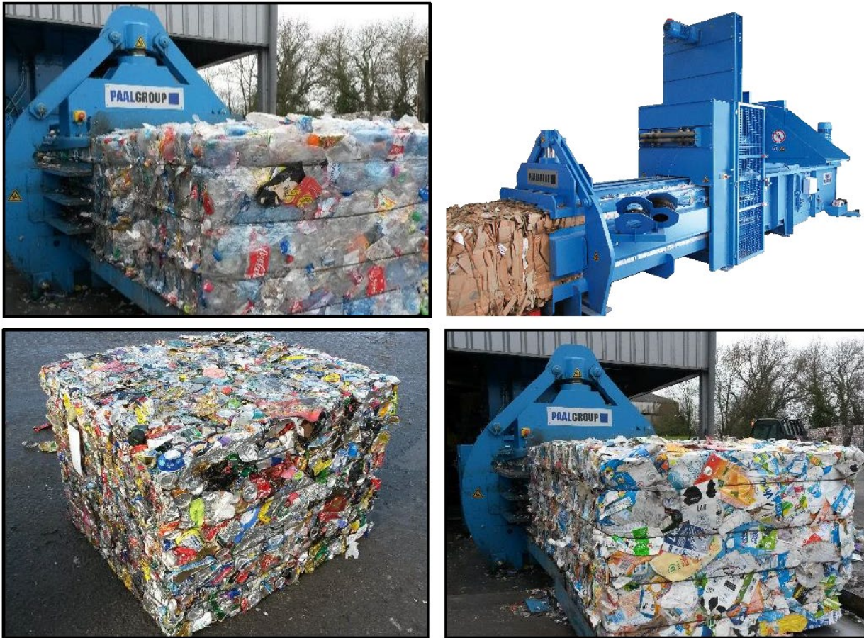
Figure 2 : exemple de visuel de la presse et des balles de déchets générées
