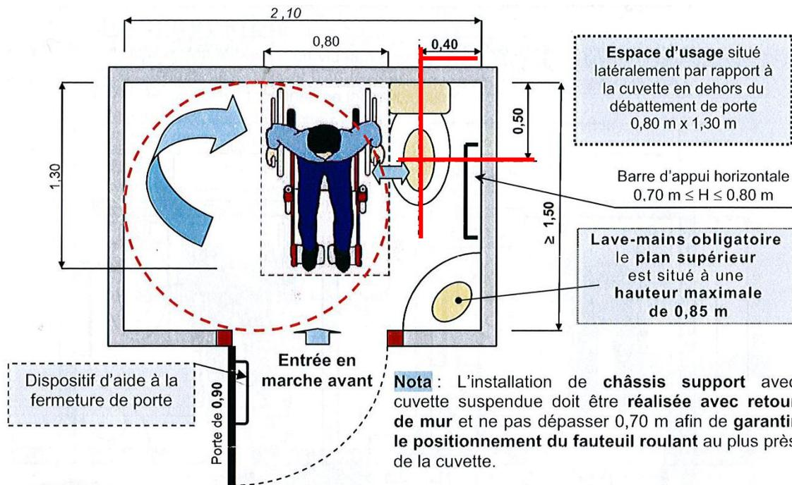
**Attention**, l'axe du wc doit être à 0.40m du mur. La barre d'appui est située à côté du wc, si le wc est éloigné du mur, une barre d'appui relevable sera installée. Déplacer le lavabo face au wc.
