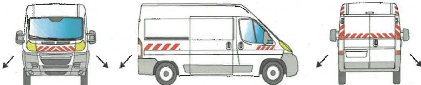
Les bandes adhésives doivent être rétro-réfléchissantes. Le numéro d'homologation TPESC doit apparaître sur chaque hachure blanche. Les bandes rétro-réfléchissantes classe B (ou classe 2) sont visibles à 250 mètres. Elles sont utilisées sur le réseau routier où la vitesse est supérieure ou égale à 90 km/h.
